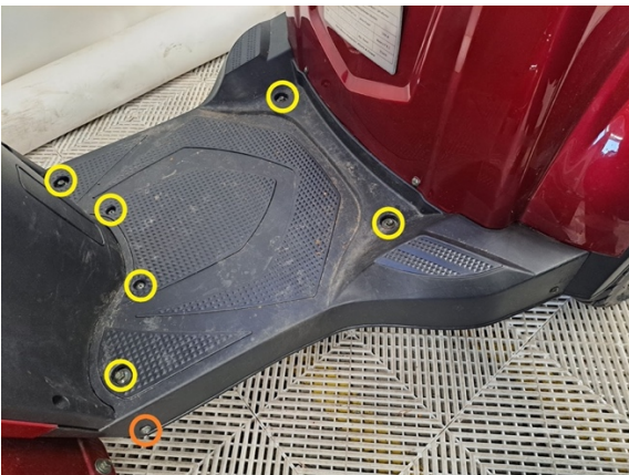
Irrota jalkatilan kiinnityspultit (hylsy 8 mm) ja kiinnitysruuvit. (ristipäämeisseli ph2). Oranssilla ympyröidyllä kiinnitysruuvilla on myös vastakkaisella puolella kiinnitysruuvi.
