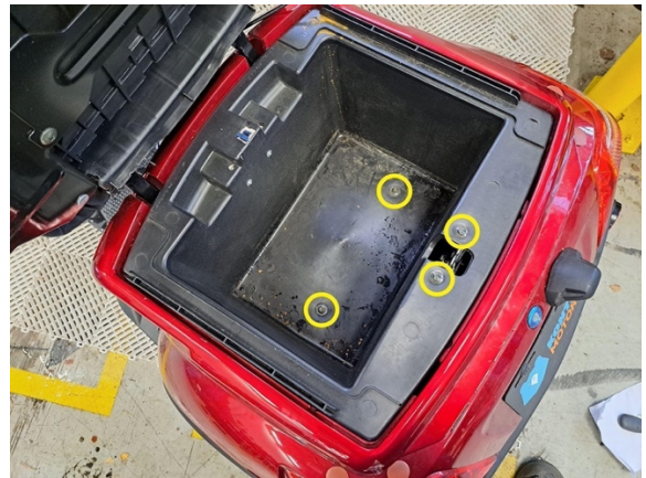
Irrota säilytyslokeron kiinnityspultit. (hylsy 8 mm).
