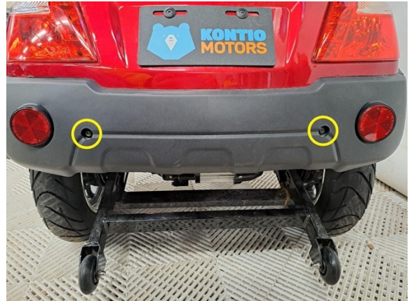
Irrota takakatteen kaksi kiinnityspulttia, (hylsy 8 mm) joilla on vastamutterit. (kiintoavain 10 mm).
